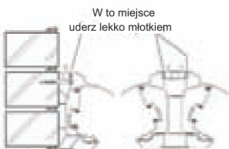
Upewnij że się uderzasz w prawidłowe miejsca kiedy stukasz w nakładki. Jak jest zimna pogoda to można uderzać poprzez kawałek drewna żeby rozszerzyć zderzenia nakładki PCV.
